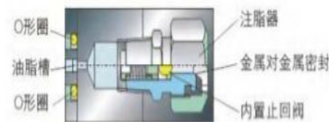
图5. 阀杆注脂及带压更换注脂器设计
