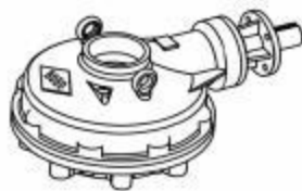
带连接电动装置的法兰标准: ISO 5210
